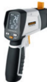
Dieses Messgerät eignet sich zur Vorbeugung von Schäden an der Gebäudesubstanz durch die Lokalisierung von Wärmebrücken und Kondensationsfeuchte. Das Infrarotthermometer ermittelt die Oberflächentemperatur, die Umgebungstemperatur, die relative Luftfeuchtigkeit und die Taupunkttemperatur. Auch Temperaturmessungen an schlecht zugänglichen Stellen oder gefährdeten Messzonen sind möglich. Das praktische Multifunktionsdisplay zeigt unterschiedliche Messwerte simultan an.
