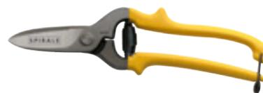
Zum Einschneiden und Ausklinken harter Beläge, vor allem Designbeläge, Lino, Nadelvlies, Sisal oder Kokos. Lange Griffe und kurze gezahnte Schneiden sorgen für einen kraftvollen Schnitt. Gesamtlänge 24 cm, Schneidlänge 4,5 cm, gezahnt.
